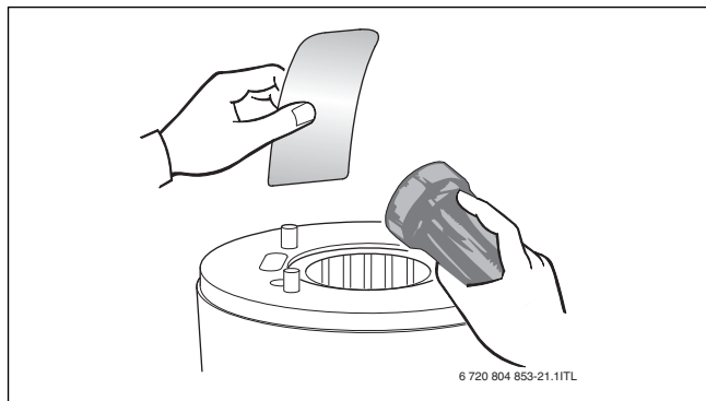
Рис. 62 Проверка наличия грязи в теплообменнике
