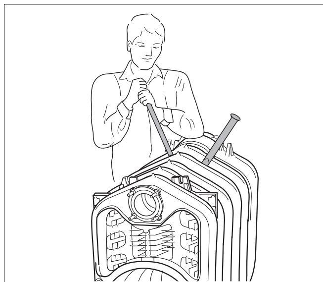
Рис. 28 Разъединение секций котла
